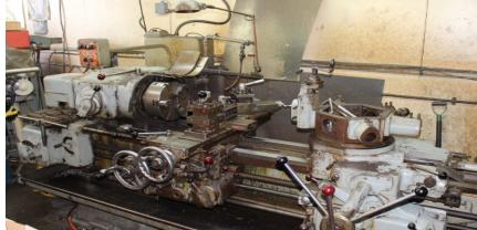
7A UNIVERSAL TURRET LATHE, SWING OVER BED: 21-1/4", SWING OVER CROSS SLIDE: 13", SPINDLE NOSE TO TURRET FACE: 50", MAXIMUM TURNING LENGTH: 35", SPINDLE HOLE: 5-1/4", COLLET TUBE 1.D: 4-3/4", SPINDLE SPEEDS: (12) 20 TO 1000 RPM, LONGITUDINAL CROSS SLIDING TURRET, 30 HP
